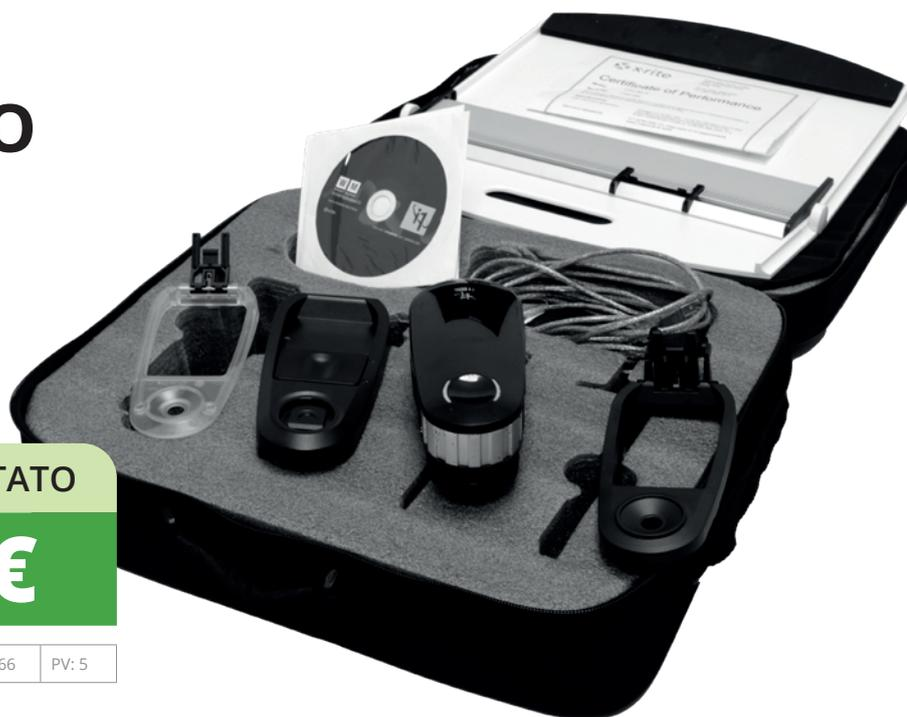
Spettrofotometro manuale in ottime condizioni, completo di borsa e tutti gli accessori, compresa tavola e righello per le misurazioni. È la soluzione ideale per i professionisti dell'imaging che devono poter contare sull'accuratezza cromatica di display e stampanti e che hanno bisogno di acquisire misurazioni dei colori spot. Una sorgente luminosa LED personalizzata a spettro completo consente la scansione in un unico passaggio e migliora la precisione e l'affidabilità del dispositivo.
