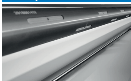
Dettaglio pali pneumatici ferma bobina
